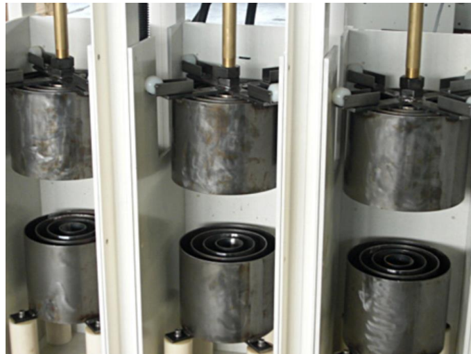
Elektrodensysteme eines drei-phasigen Flüssigkeitsanlassers ( Bild: Pape&Olbertz), unten: Festelektroden, oben: Tauchelektroden
