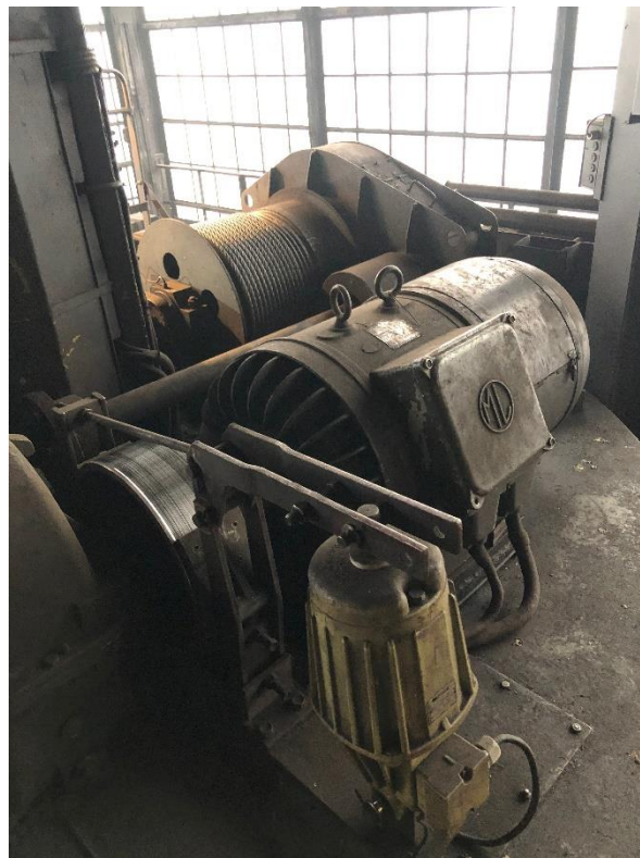
Klassischer Hubwerksantrieb mit Schleifringläufermotor mit elektrohydraulischer Bremse, Vorgelege, Getriebe und zwei Seiltrommeln. Im Einsatz als Hüttenkran bei BGH.
